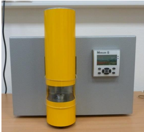
Obr. 11 Použitie zariadenie na testovanie tvrdosti peliet od firmy KAHL
