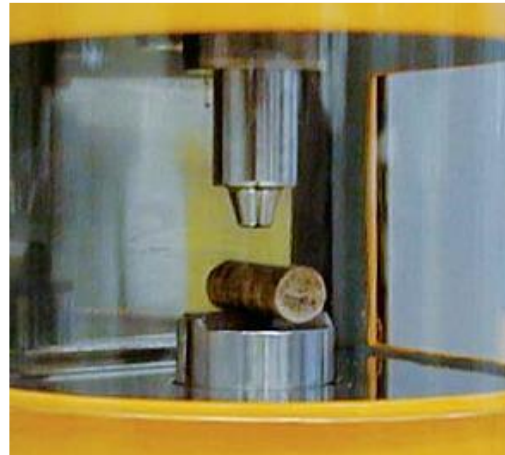
Obr. 11 Použitie zariadenie na testovanie tvrdosti peliet od firmy KAHL
